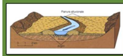
**Fiumi Uniti è un FIUME PENSILE:** condizione frequente nei corsi d'acqua di pianura arginati i cui sedimenti, non potendosi depositare nella piana alluvionale, si accumulano nell'alveo, sopraelevandolo rispetto al piano di campagna circostante.
